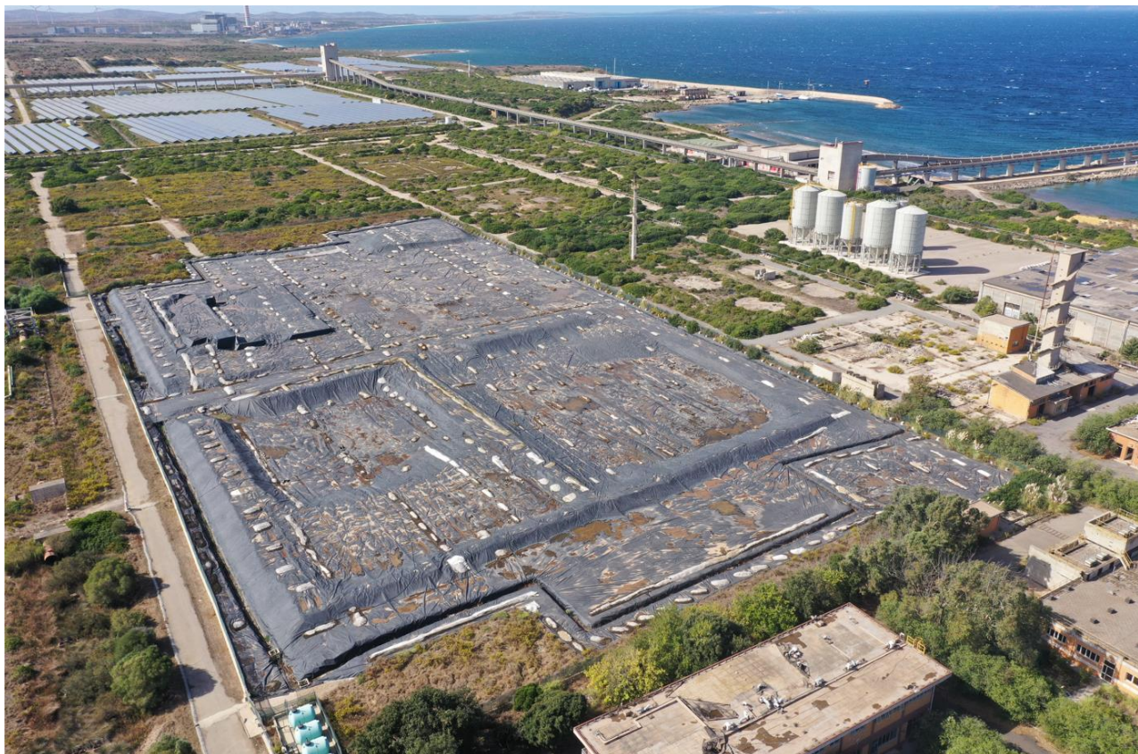
Figura 6.13 - Vista Aerea -Area Palte con impermeabilizzazione.
